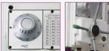
Die Kupplung des automatischen Pinolenvorschubs kann bei tiefen Bohrungen oder Sacklochbohrungen jederzeit durch Betätigung des Tasters am Vorschubgriff geöffnet oder geschlossen werden.
