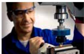
Beim Thermobohren wird durch Reibungshitze aus dem vorhandenen Material spanlos eine verdrehsichere Buchse geformt und dann ein Gewinde eingebracht.
