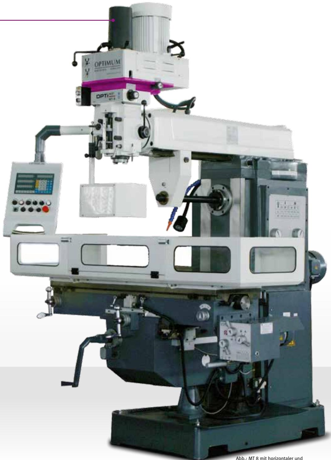
Abb.: MT 8 mit horizontaler und vertikaler Fräsposition
