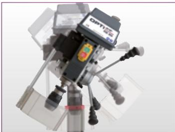
› Der Bohrkopf ist  $\pm 45^\circ$  neigbar
